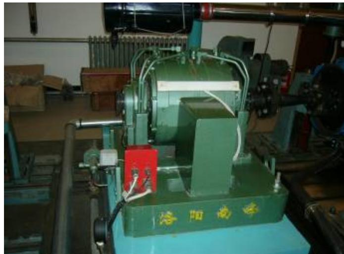
发动机与电涡流测功相连，可测量和控制转速与负荷。
